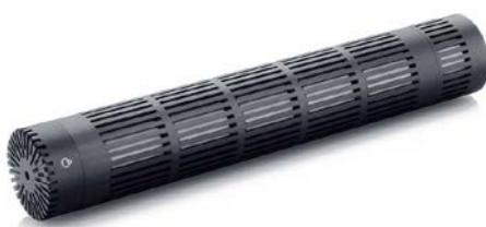
Esta cápsula de micrófono de condensador es parte de nuestra gama de micrófonos tipo lápiz. Está equipado con un patrón de captación hipercardioide altamente direccional; obtenido utilizando un diseño supercardioide con un tubo de interferencia que proporciona un excelente rechazo fuera del eje.
